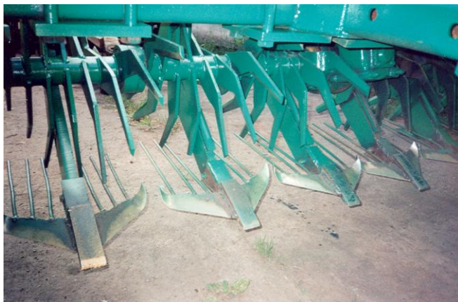
Рис. 1 – Рабочие органы для подрезания и подачи почвы к рыхлительно-сепарирующему устройству
