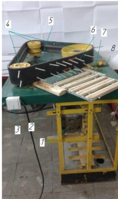
Рис. 1 – Експериментальна установка для дослідження збирання стебел конопель
