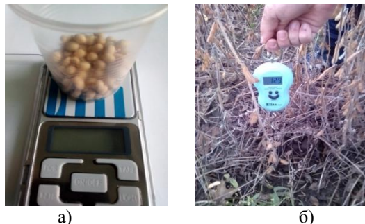
Рис. 4 – Дослідження зусиль терезлення стебла сої з ґрунту та визначення масових показників насіння
