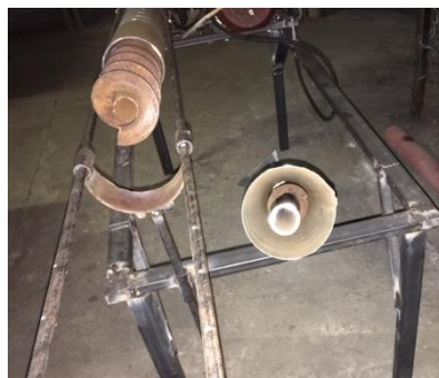
Рис. 3 - Стэнд для дослідження телескопічних гвинтових транспортерів в розібраному стані
