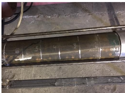
Рис. 2 – Шкала перекривання шнеків стэнду для дослідження характеристик телескопічних гвинтових транспортерів
