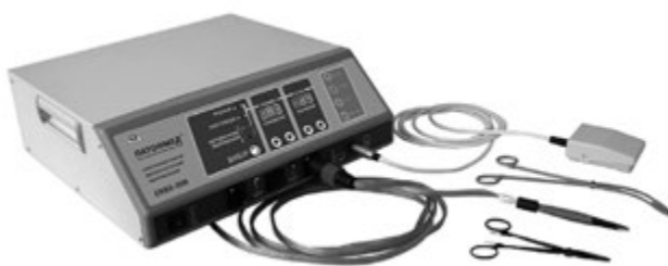
Рис. 1. Аппарат для электросварки живых тканей с набором стандартного инструментария
