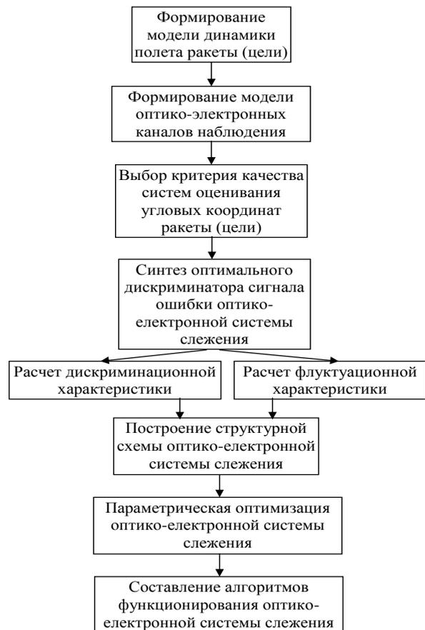
Рис. 2 Граф-схема алгоритмов синтеза
