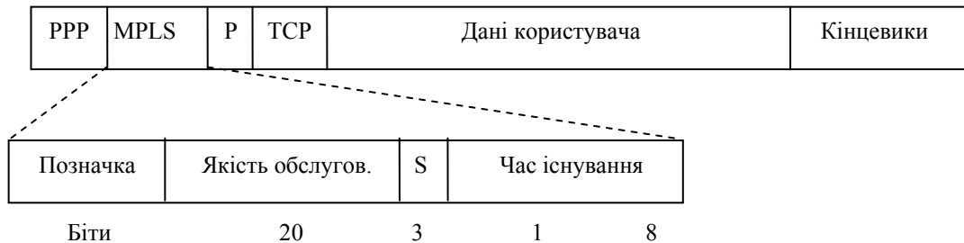
Рис. 3. Передавання TCP-сегмента з використанням IP, MPLS, PPP
