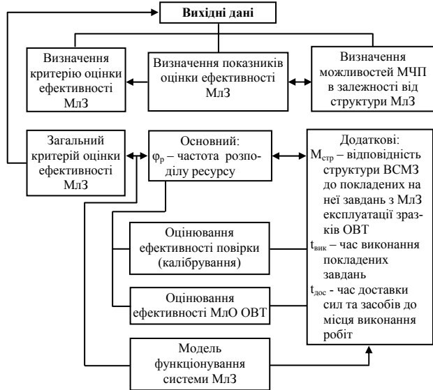
Рис. 2 Методика оцінювання ефективності МлЗ експлуатації зразків ОВТ
