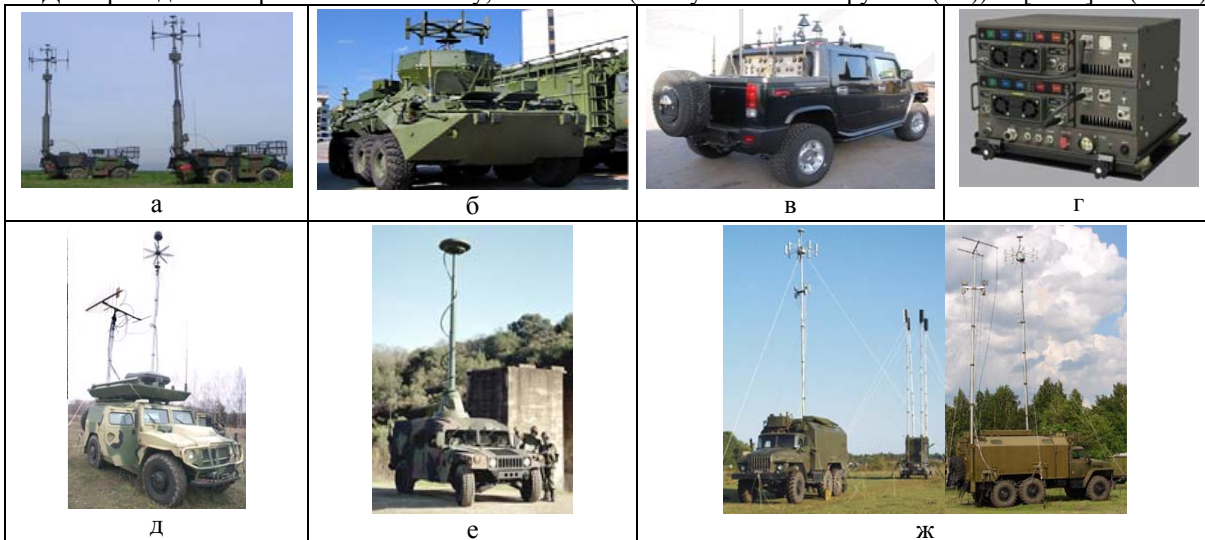
Рис.1. Багатофункціональні засоби і комплекси радіоелектронної боротьби: а – TRC 274SDJ (Франція); б – РБ-531Б (РФ); в – VME Terminator H2 (США); г – BROADSHIELD HCS, L-3 TRL Technology (Великобританія); д – «Леер-2», ТОВ "НДІ «Еталон»" (РФ); е – AN/MLQ-40 (США); ж – «Діабазол» (РФ)
