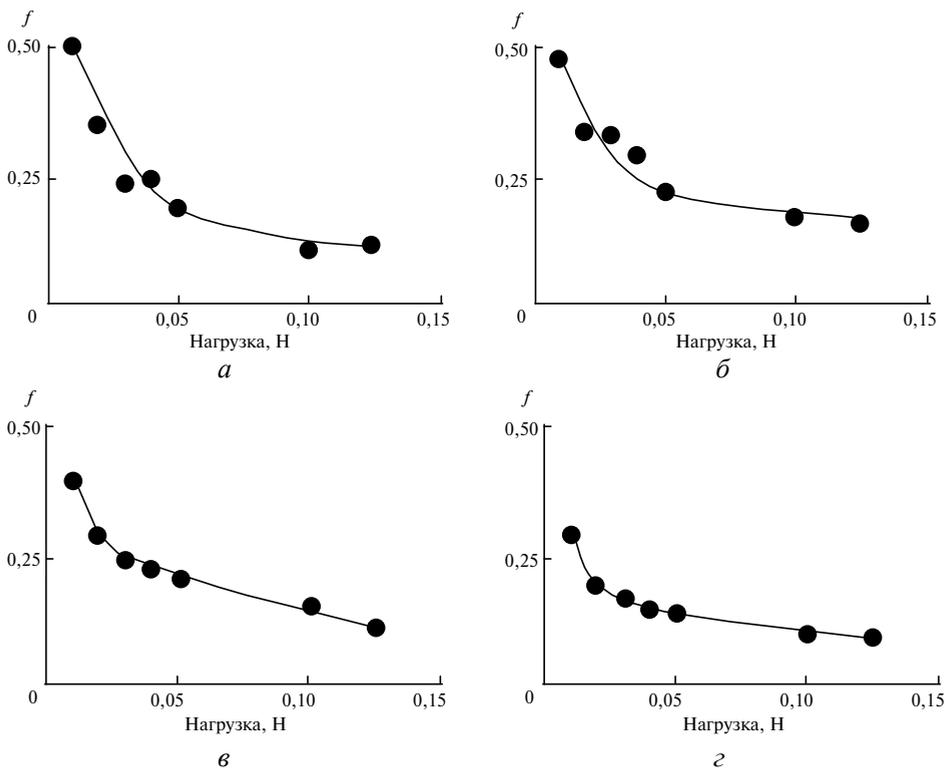
Влияние нагрузки на коэффициент трения  $f$  алмазной пирамиды по сверхтвердым материалам на основе BN, % (по объему):  $a$  – 100сBN;  $б$  – 75сBN + 25wBN;  $в$  – 25сBN + 75wBN;  $г$  – 100wBN; испытания проводили при скорости скольжения алмазной пирамиды по поверхности образцов  $v = 4,2 \cdot 10^{-4}$  м/с и нагрузке  $P = 0,010-0,125$  Н; среда – воздух.
