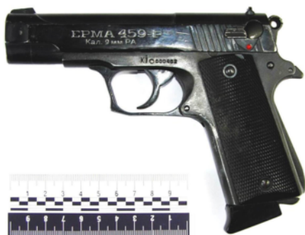
Рис. 1. Загальний вигляд гладкоствольного пістолета “ЕРМА-459Р” калібру 9 мм.
