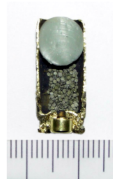
Рис. 3. Загальний вигляд патрону “ПНД-9П” на повздовжньому зрізі.
