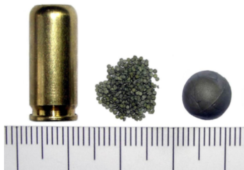
Рис. 2. Загальний вигляд компонентів патрону “ПНД-9П” (гільза з капсулем, пороховий заряд і куля).
