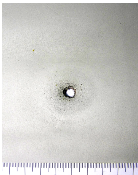
Рис. 10. Пошкодження натуральної шкіри. Відстань пострілу – 5 см.
