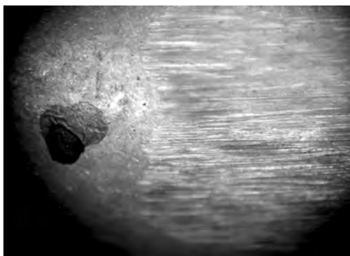
Фото 1. Результат суміщення співпадаючих окремих ознак слідів від каналу ствола на одній із трьох досліджуваних куль та одній із трьох експериментально відстріляних куль з наданого пістолету «ТТ».
