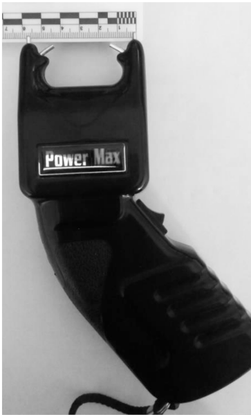
Рис. 2. Контактний електрошоковий пристрій типу stun gun
