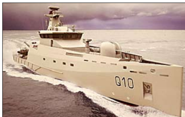
Проектное изображение малого патрульного корабля проекта Damen Stan Patrol 5009 с оригинальными обводами носовой части корпуса с вертикальным форштевнем, именуемыми «axe bow» («топорообразный нос»)
