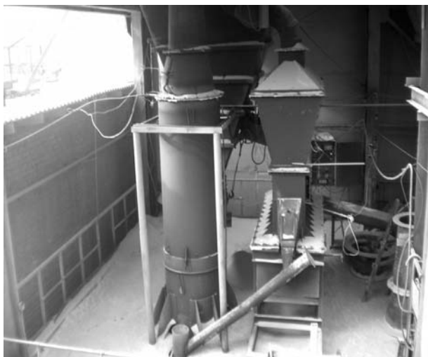
Рис. 1. Усовершенствованная двух-стадийная перлитовая установка, включающая печь термоподготовки кипящего слоя и шахтную печь вспучивания
