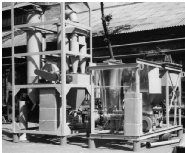
Рис. 2. Мобильная перлитовая установка, включающая коническую печь вспучивания
