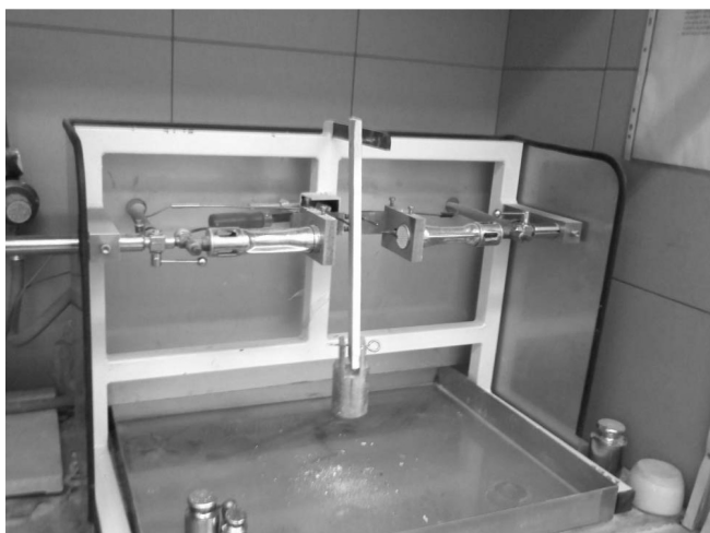
Рис. 1. Установка для випробування ГКПО на опірність впливу відкритого полум'я
