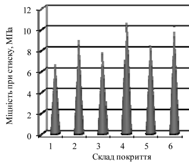
Рис. 2. Міцність при стиску покриттів (на 1 добу твердіння) на основі шлакомісткого в'язучого матеріалу з добавкою природного (а) та випаленого (б) цеоліту, модифікованого добавками солей-електролітів складу: 1) 4 ч. – \text{Na}_2\text{CO}_3 , 6 ч. – \text{Na}_2\text{SO}_4 , 10 ч. – \text{NaNO}_3 ; 2) 6 ч. – \text{Na}_2\text{CO}_3 , 8 ч. – \text{Na}_2\text{SO}_4 , 6 ч. – \text{NaNO}_3 ; 3) 8 ч. – \text{Na}_2\text{CO}_3 , 10 ч. – \text{Na}_2\text{SO}_4 , 2 ч. – \text{NaNO}_3 ; 4) склад без добавок-електролітів, 5) і 6) – склади порівняння (Кальматрон і Пенетрон)
