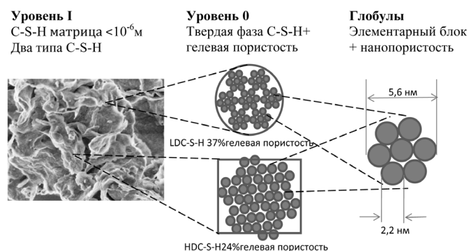
Рис. 2. Модель микроструктуры C-S-H по Х.М. Дженнингу [91]
