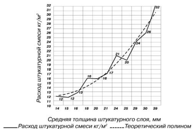
Рис. 3. Расход сухой штукатурной смеси кг/м 2 в зависимости от средней толщины штукатурного слоя, мм
