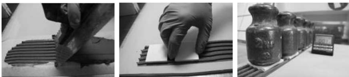
Фото 2. Нанесення розчинової суміші з послідовним вкладанням керамічної плитки та її привантаженням гирею 2 кг
