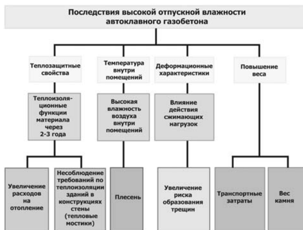
Рис. 1. Последствия от высокой технологической влажности автоклавного ячеистого бетона при нарушении правил эксплуатации
