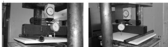
Фото 3. Приспособление для испытания стыков гипсокартонных образцов
