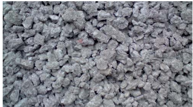
Рис. 1. Фрагмент фільтрат бетону, будівельний майданчик біля м. Бориспіля.
