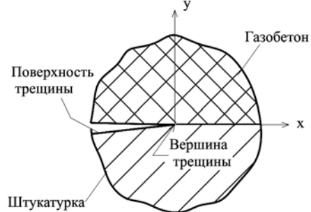
Рис. 7. Трещина в контактной зоне
