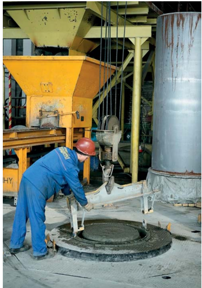
Рис. 1. ПАТ «Комбінат будіндустрії» процес підняття труби з установки формування «Pedershaab»
