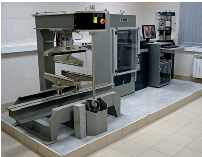
Рис. 1. Автоматичний випробувальний комплекс «МСС 8» Зліва направо: рама для визначення згину 300 Кн; прес для визначення міцності при стиску бетонних зразків 400 Кн; консоль; система забезпечення преса для випробування цементно-піщаних зразків.
