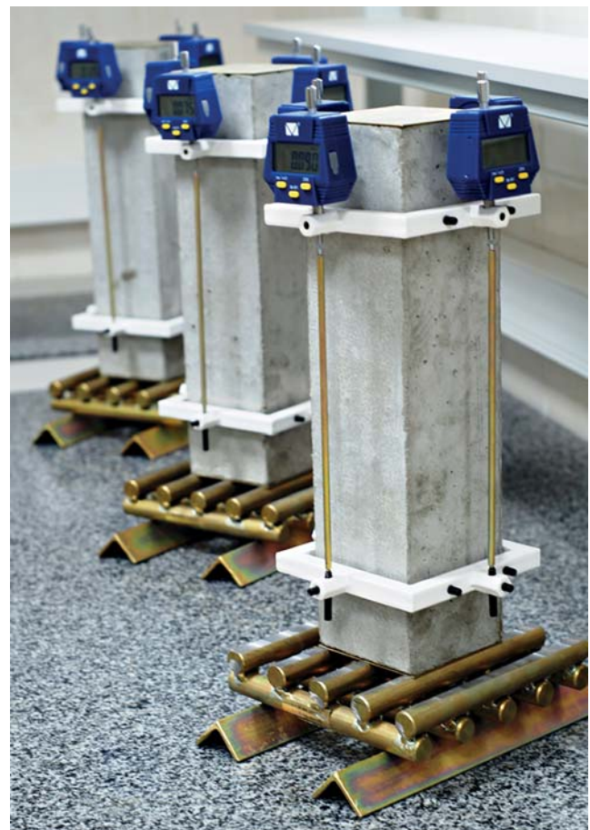
Рис. 3. Проведення випробування по визначенню деформацій усадки бетону
