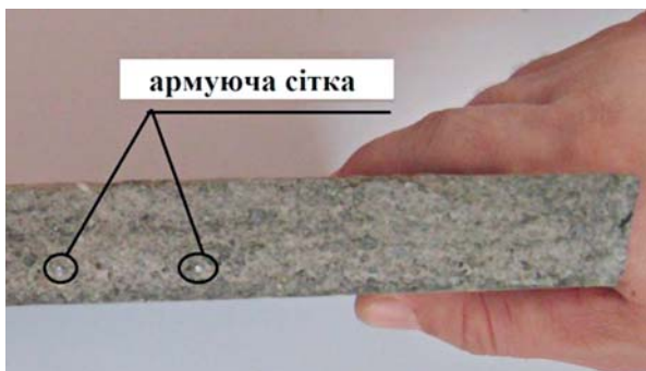
Рис. 3. Зразок з дрібнозернистого бетону армованого тканною сіткою, що виготовлено за допомогою металевого пристрою
