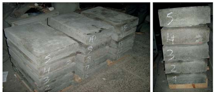
Рис. 2. Зразки (110x50x10 см) бетонної підлоги виготовлені за допомогою металевого пристрою
