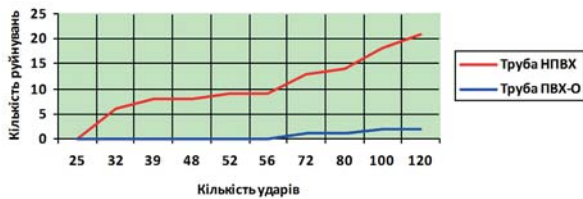
Рис.2. Графік руйнувань труб з НПВХ і труб з ПВХ-О в аналізі на опір удару падаючого вантажу
