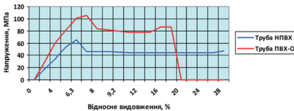
Рис. 3. Графік відносного подовження труб при розриві і межі текучості при розтягу труб з НПВХ і труб з ПВХ-О
