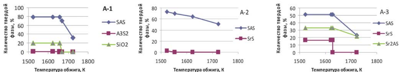
Рис. 3. Температурная зависимость фазового состава продуктов термообработки модельных композиций А-1, А-2 и А-3
