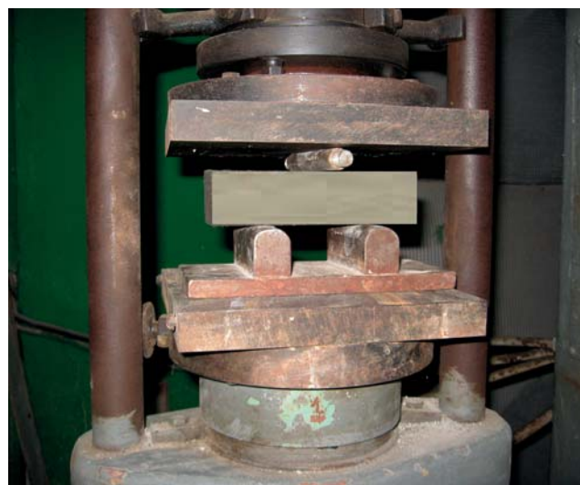
Рис. 1. Испытание прочности балочки на изгиб
