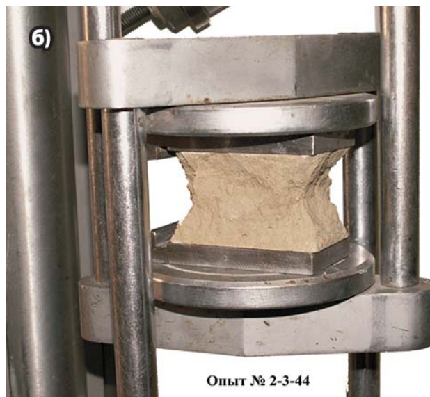
Рис. 4. Испытание образца балочки твердеющего раствора при сжатии а) – общий вид испытательной машины MP-05-1; б) испытание образца
