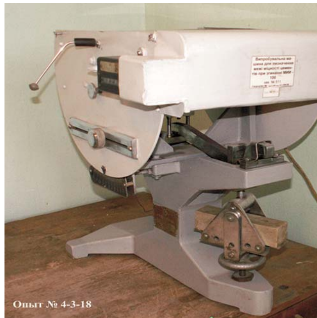
Рис. 3 Испытание образцов балочек затвердевшего раствора на растяжение при изгибе на приборе МИИ-100
