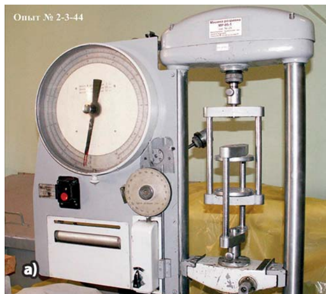
Рис. 3 Испытание образцов балочек затвердевшего раствора на растяжение при изгибе на приборе МИИ-100
