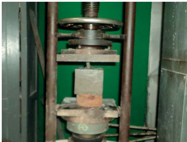
Рис. 5. Лабораторная установка для испытания образцов базальтопластиковой арматуры
