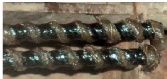
Рис. 3. Изготовленные образцы базальтопластиковой арматуры с обвивкой джутовой нитью
