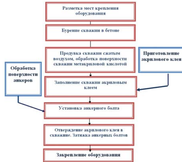
Рис. 1. – Схема технологического процесса крепления оборудования на клеевых анкерах
