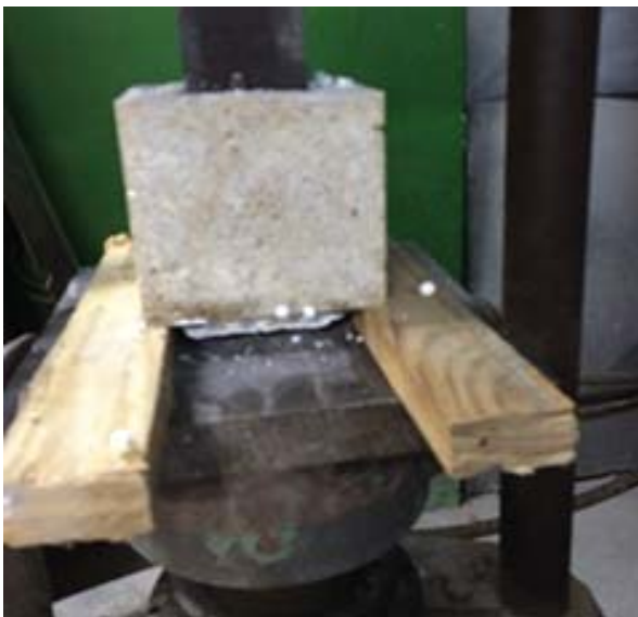
Рис. 2. Испытание сцепления бетонного сердечника с обоймой
