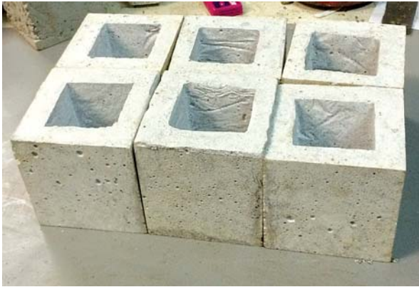
Рис. 1. Пустотелые образцы кубической формы перед заполнением сердечника теплоизоляционной бетонной смесью
