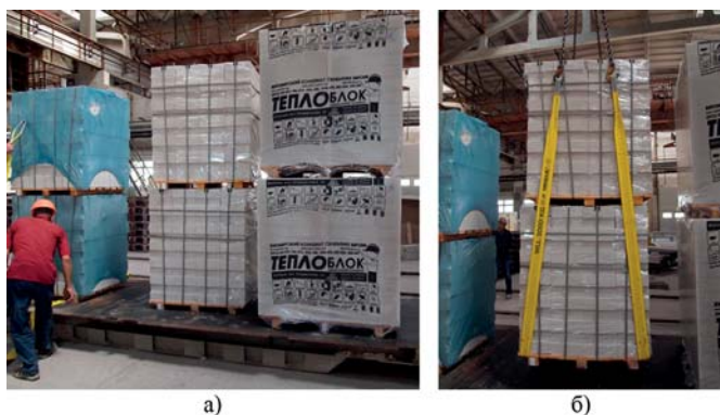
Рис. 4. Испытания пакетов кирпича и блоков: а – статические; б – динамические
