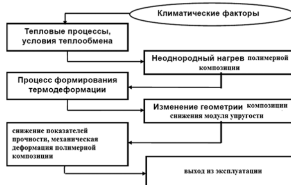
Рис. 2. Схема влияния климатических факторов на физические характеристики полимерных композиций
