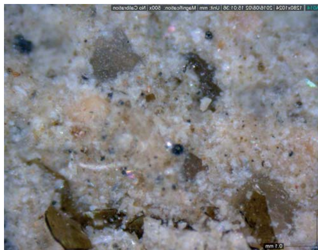
Рисунок 6. Фотографії мікроструктури покриття з армуючими компонентами: а) ППФ – 1%; б) БФ – 1%; в) БЛ – 1%;
