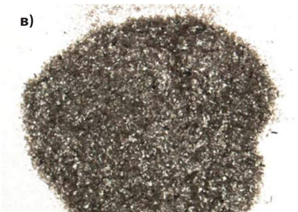
Рисунок 1. Армуючі компоненти для захисних покриттів: а) поліпропіленова фібра; б) базальтова фібра; в) базальтова луска
