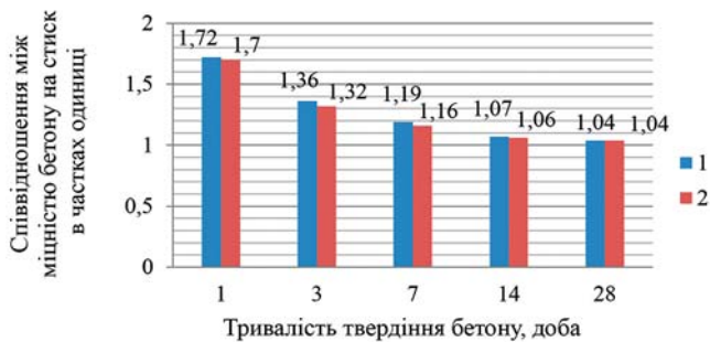
Рис. 4. Співвідношення між міцністю бетону на стиск при його твердінні із застосуванням теплової обробки та без теплової обробки (дослід 1): 1 – для плит; 2 – для кубів
