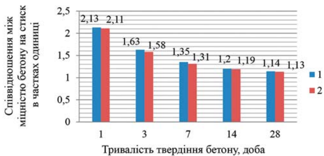
Рис. 5. Співвідношення між міцністю бетону на стиск при його твердінні із застосуванням теплової обробки та без теплової обробки (дослід 2): 1 – для плит; 2 – для кубів
