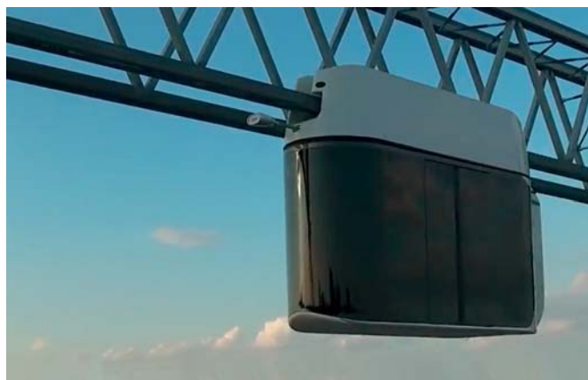
Рис. 1. Испытания 14 местного юнибуса на жесткой рельсовой структуре [1]
