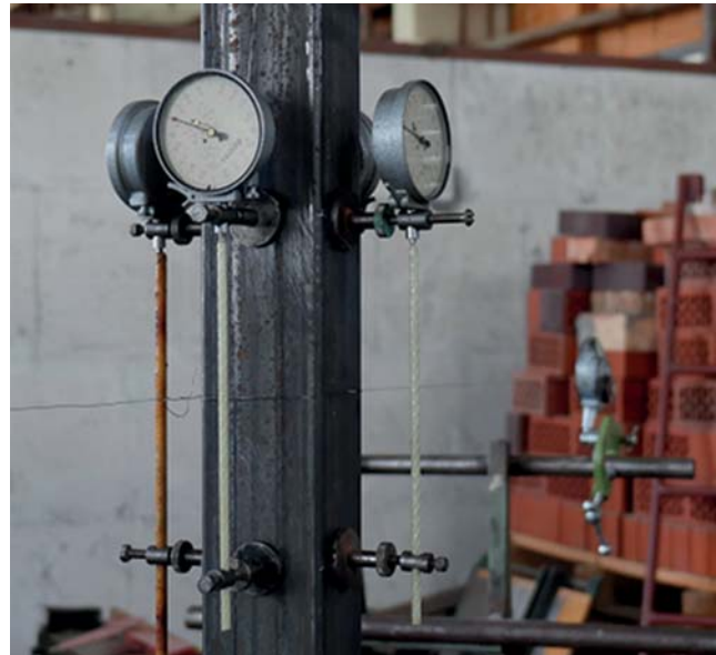
Рис. 9. Расположение измерительных приборов при испытании труботбетона на сжатие
