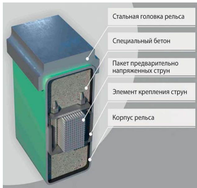
Рис. 2. Устройство струнного рельса.
