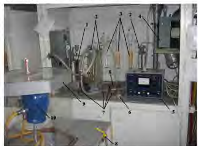
Рис. 5. Загальний вигляд стенду: 1 – генератор аерозолу; 2 – ротаметри; 3 – мікроманометри рідинні; 4 – аспіратор; 5 – інтегральний фотометр; 6 – трьохходовий вентиль; 7, 8 – регульовані вентилі; 9 – випробувальна камера; 10 – спеціальна посадка для закріплення півмаски або муляж голови (для фільтрів тільки посадка) / Overall
