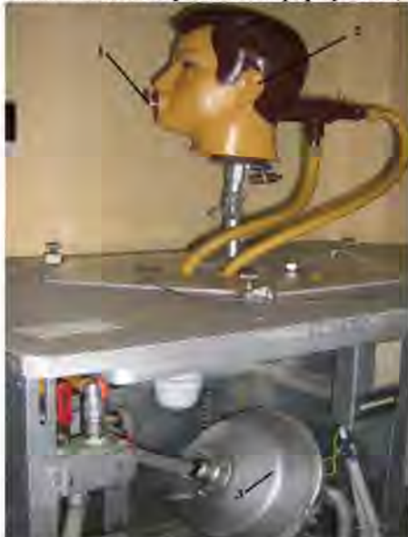
Рис. 4. Стенд для визначення опору півмасок: 1 – пробовідбірник з підмаскового простору ЗІЗОД; 2 – шеффілдський манікен голови; 3 – дихальна машина / Stand to determine half-mask resistance: 1 – sampling device from MIPRO undermask space; 2 – Sheffield dummy head; 3 – respiratory machine
