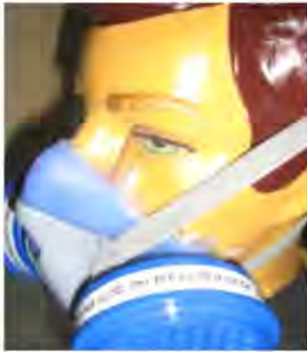
Рис. 3. Муляж голови з розміщеними трубками за смугою обтюрації / Dummy head with the tubes arranged along obturation line
