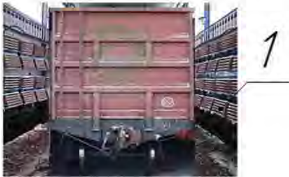
Рис. 1. Размещение вагона с углем в цеху угледоготовки: 1 – элементы с инфракрасным излучением для размораживания угля / Allocation of wagon with coal in coalshop: 1 - infrared elements for defrosting coal.
