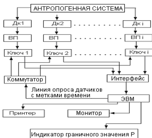
Рис. 2 – Функциональная схема контрольно-измерительной системы технической диагностики / Functional diagram of the control and measuring technology diagnostic system
