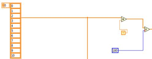
Рис. 3. Преобразование углов в радианы / Transformation of corners to the radians
