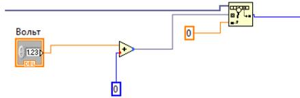
Рис. 6. Подключенная функция Search 1D Array / Connected function Search 1D Array
