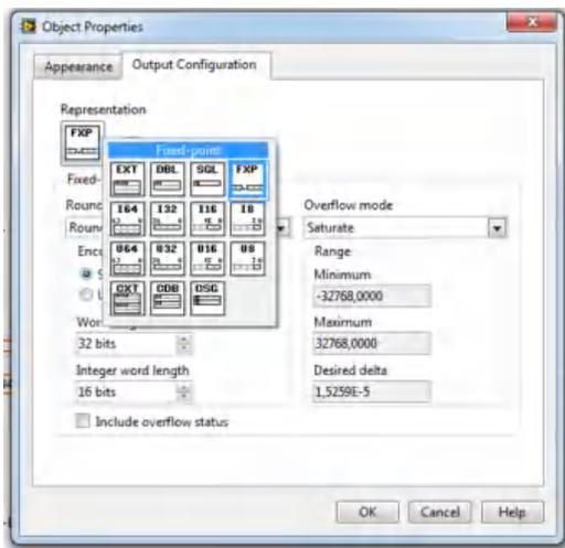
Рис. 7. Задание типа данных с фиксированной точностью / Task of type of data with the fixed exactness
