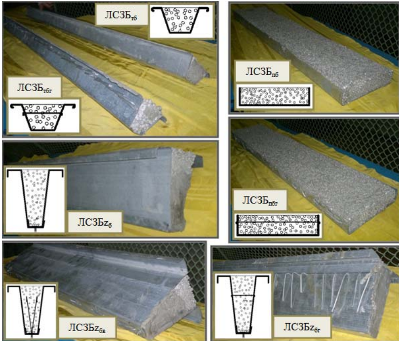
Рис. 4 Вигляд та схеми дослідних зразків заповнених полістиролбетоном
