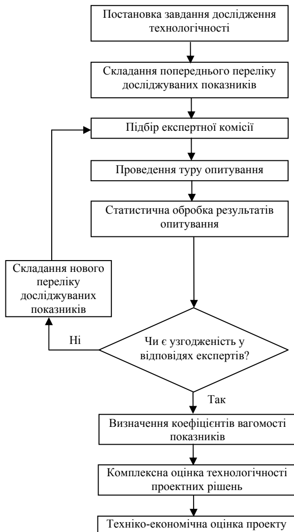
Рис. 1. Блок-схема застосування методу експертних оцінок до оцінки технологічності проектних рішень
