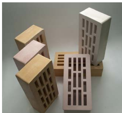
Рис. 3. Кирпичи карбонизационного типа твердения из опытной партии
