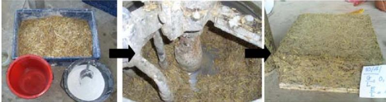
Figure 3 : Procédure de confection des échantillons de Béton-Paille
