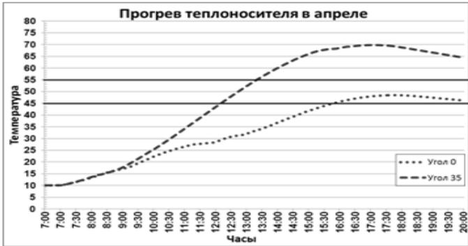
Рис 3. График прогрева теплоносителя в апреле
