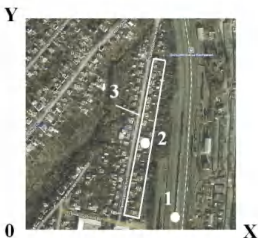
Рис. 1. Вид расчетной области (станция Днепропетровск–Грузовой): 1 – начальное положение тепловоза для момента времени t=0 ; 2 – положение рецептора; 3 – селитебная зона /
