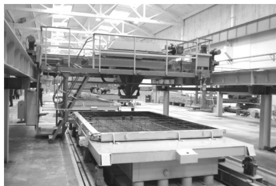
Рис.7. Производство стеновой панели на карусельной установке / Production of a wall panel on the merry-go-round setting
