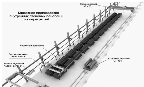
Рис.5. Схема цеха по производству стеновых панелей / Chart of workshop on the production of wall panels
